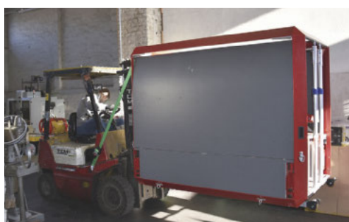
Zügiger Modulwechsel mit dem Gabelstapler
