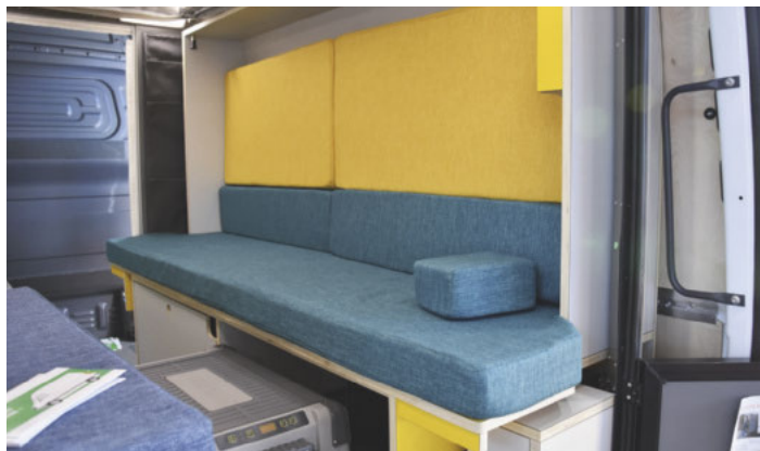
Das seitlich ausfahrbare Modul nutzt die volle Fahrzeugbreite
